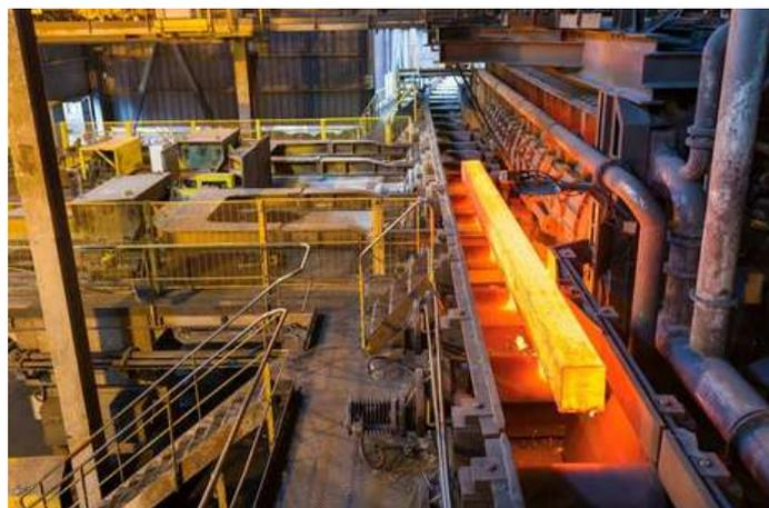
**Fig. 57 - Production des rails par les fours électriques de l'usine Saarstahl Rail d'Hayange**
