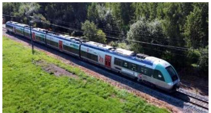
**Fig. 62 - Automoteur bimode (batterie ou caténaire) rétrofité en expérimentation**
